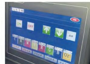
Pantalla de monitoreo LCD, para detectar la estabilidad del sistema de tinta y el paso a paso. Fácil de operar y ajustar.
