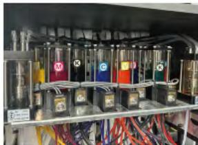
Sistema de presión negativa de tinta, mejor fluidez de la tinta, asegurando estabilidad de la producción de alta velocidad.
