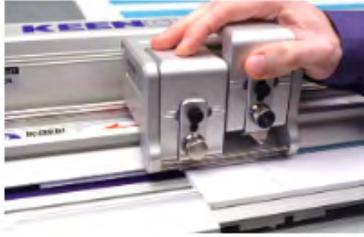
El sistema de rodillos de pista autoajustable instalado en las cabezas de herramientas QuikSwap proporciona un movimiento fuerte y suave hacia arriba y hacia abajo a lo largo de la barra cortadora, sin ningún movimiento lateral para garantizar una línea recta perfecta. Esto, junto con la sujeción rígida de la cuchilla, brinda un control perfecto de la cuchilla y una precisión impecable, lo que resulta en menos desperdicio y errores.
