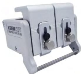
El cabezal de herramienta Evolution3 Double Graphik viene de serie e incluye dos portacuchillas individuales para corte bidireccional. Las cuchillas son más fuertes y estables que las cuchillas regulares, lo que hace que la herramienta Double Graphik sea ideal para vinilo, pancartas, cartón, espuma de PVC de hasta 13 mm (1/2"), tablero con núcleo de espuma, plástico corrugado, papel, materiales emergentes y enrollables.
