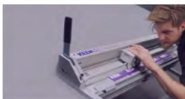
El Evolution3 es el cortador más preciso de su tipo en el mercado y está garantizado para cortar dentro de 0.2mm (0.008 pulgadas) de una línea recta a lo largo de toda la longitud del corte. La precisión ultra-alta incorporada, combinada con la alineación perfecta posible gracias a la tira de línea de visión, significa que cada panel unido a tope se unirá sin problemas. Esta precisión ultra-alta te ahorrará tiempo y dinero con menos desperdicio y menos errores.
