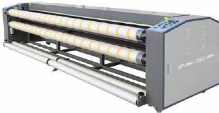
Laminadora líquida diseñada para barnizar impresiones de tinta solventes, eco-solventes y UV. El recubrimiento de barniz protege impresiones de tinta en vinilo, lonas, lienzo, papel de pared, lonas para camiones, etc.
